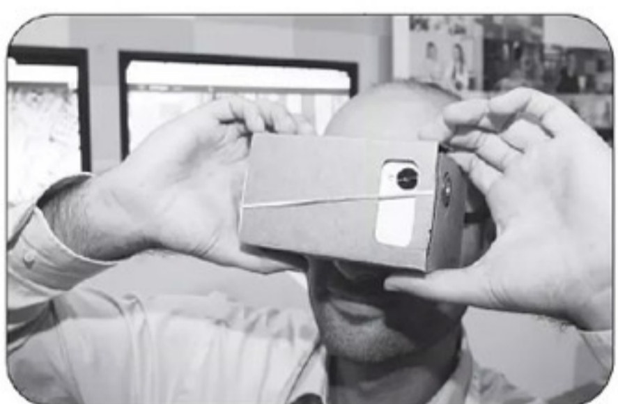
段ボールを組み立ててスマホやレンズをセットする「ゴーグルカードボード」は1000~1500円程度
